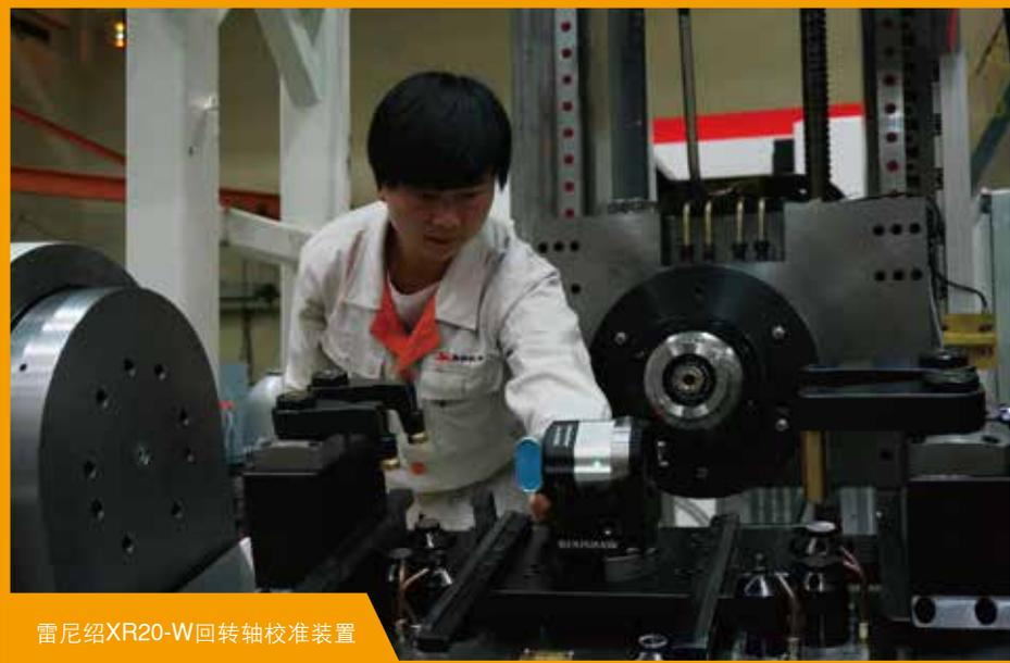
雷尼绍XR20-W回转轴校准装置
