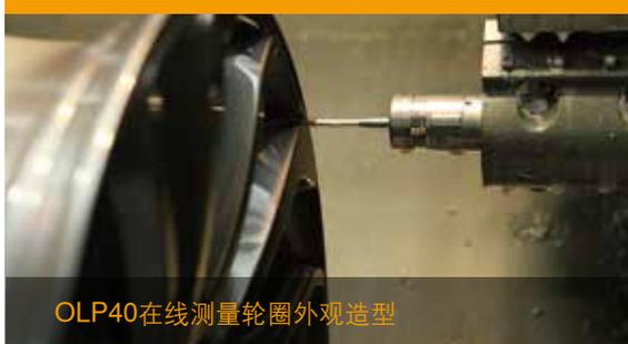
OLP40在线测量轮圈外观造型
